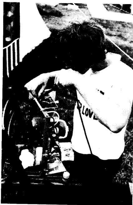
Reparatie in Luxemburg . . . Gerard, PE1BTX, tijdens het repareren van de eindtrap met 4CX 250-b.
